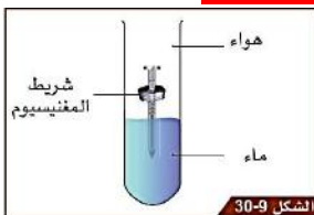
التفاف شريط المغنيسيوم بإحكام حول مسمار الحديد (الحماية بالحاجز المضحّي).
